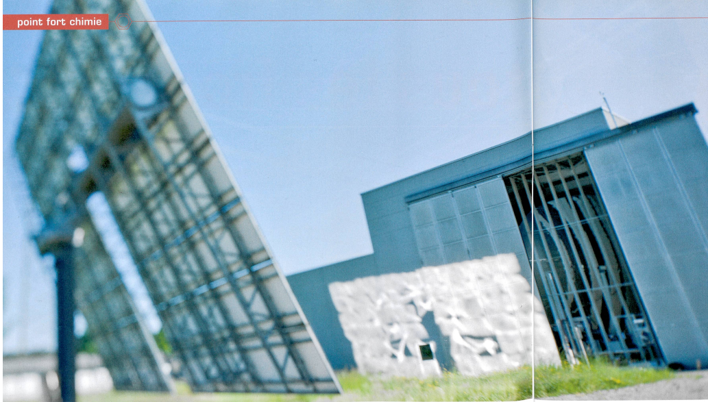
Les miroirs de notre avenir. Le four solaire de l'Institut Paul Scherrer (PSI) est capable de concentrer jusqu'à 5000 fois le rayonnement solaire. Cela permet de tester des réacteurs solaires à haute température. Photo: Denis L. Huet/PSI
