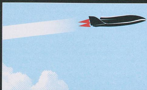
**2** Le véhicule suisse baptisé Soar mesure quelque 15 mètres sur 10. Il atteindra une vitesse de 7 600 km/h et l'altitude de 80 kilomètres, une zone où les effets de l'atmosphère deviennent négligeables. Il sera propulsé par une version modifiée du moteur de fusée russe NK-39, de la famille de celui qui équipe le troisième étage du lanceur Soyouz. Le groupe français Dassault Aviation fournira notamment le poste de pilotage au sol, basé sur celui de son drone de combat furtif Neuron.
