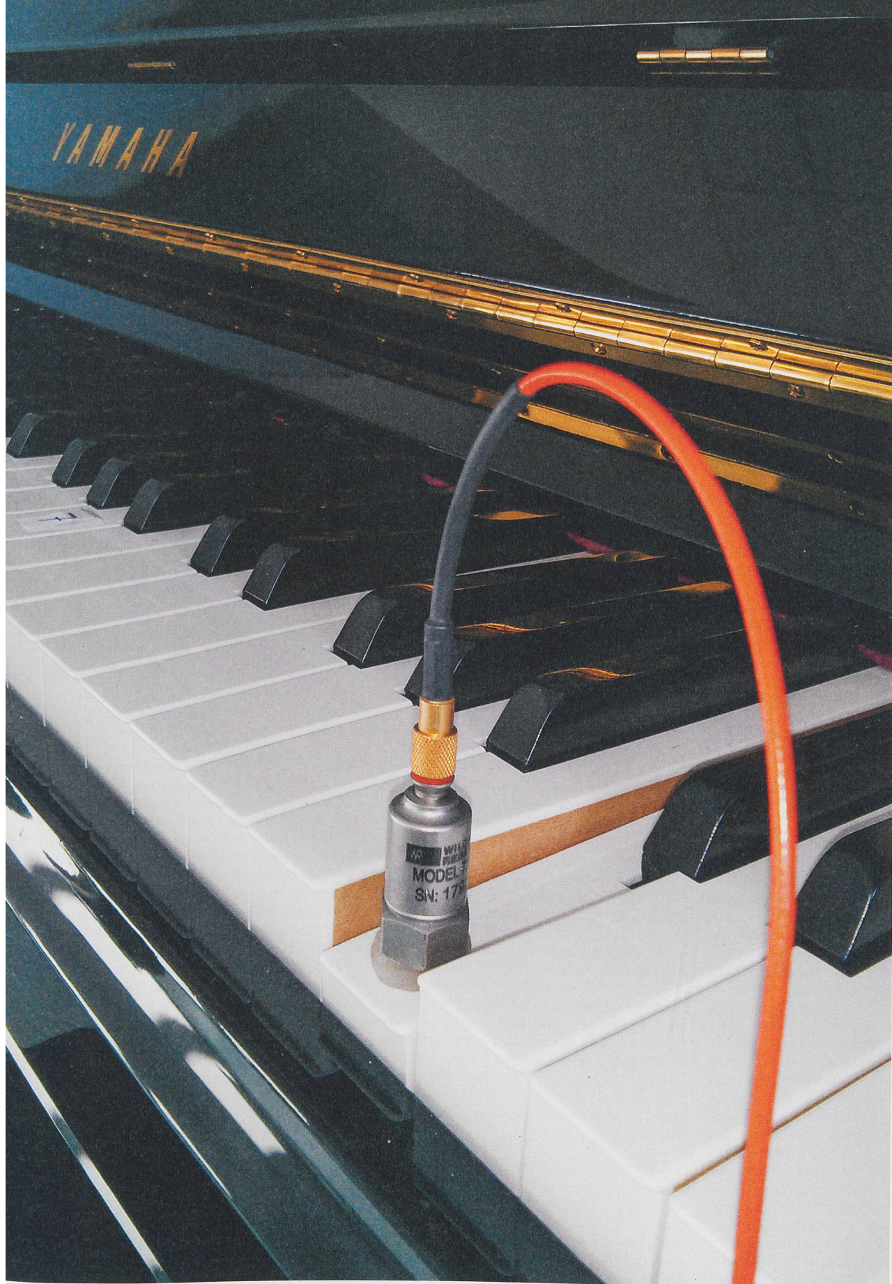
A l'aide d'un accéléromètre, les chercheurs mesurent systématiquement les vibrations des touches d'un piano. Ils peuvent ainsi les reproduire sur un instrument électronique. Photo: Stefano Papetti
