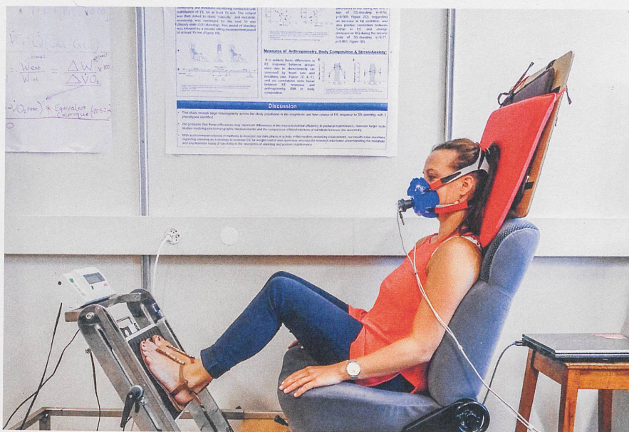
Une participante appuie sur une pédale toutes les trente secondes; la consommation d'oxygène permet de déduire la quantité de calories brûlées. Photo: Clemens Weber
