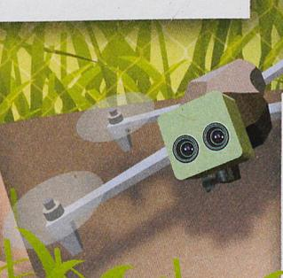
**Fotokite** se définit comme robuste, éprouvé et indépendant. Il survole avec calme et sans pilote les lieux d'accidents où règne la confusion et fournit des images aériennes aux forces d'intervention pendant des heures grâce à son câble électrique et à sa caméra thermique. Origine: ETH Zurich.
