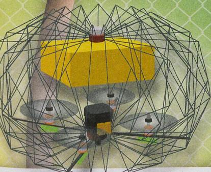
**Verity** se déplace en essaim. Célèbre pour ses spectacles lumineux, il navigue également avec aisance à l'intérieur grâce à sa géolocalisation basée sur l'ultra wideband. De petite taille, léger et inoffensif. Origine: ETH Zurich.
