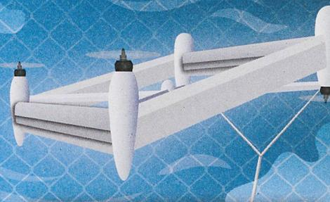
**Skypull** raffole des vents forts à 400 mètres d'altitude. Attaché par un câble à un générateur électrique placé au sol, il lui transfère l'énergie éolienne. Origine: ETH Zurich. Autre producteur de courant: Twingtec, originaire de l'EMPA, la FHNW et l'ETH Zurich.
