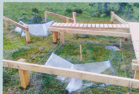
Serres en plexiglas à toit ouvert pour simuler le réchauffement dans la tourbière.
