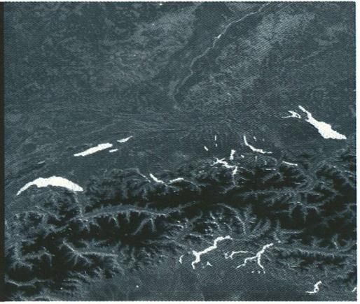
Jede Ziffer entspricht einer Anzahl von Sonnenstrahlen, die von einem Quadratmeter Erde und Wolkendecke reflektiert werden. Diese Erdflecken werden dann durch winzige Farbfelder, den Pixeln, auf dem Computerbildschirm dargestellt.
