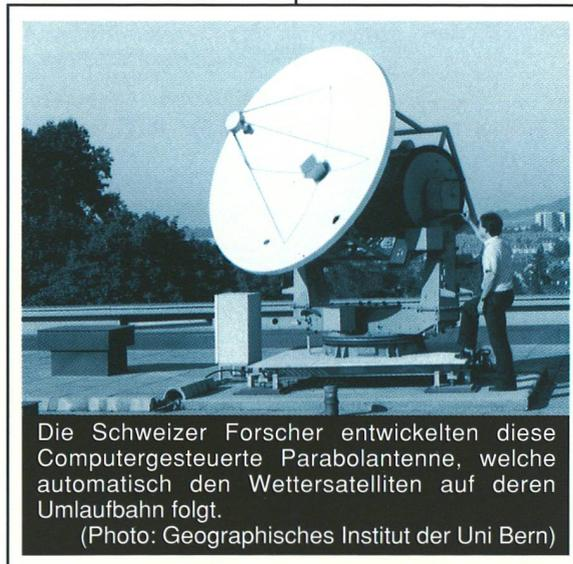
Die Schweizer Forscher entwickelten diese Computergesteuerte Parabolantenne, welche automatisch den Wettersatelliten auf deren Umlaufbahn folgt.
