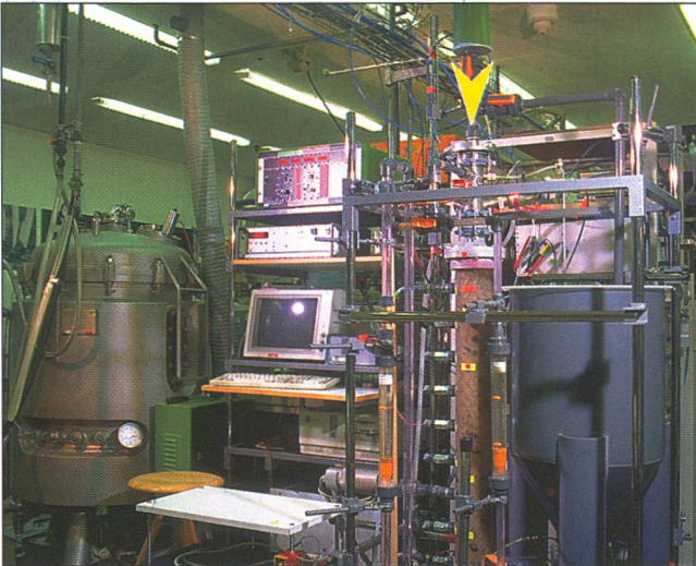
Pilotanlage zur Reinigung industrieller Abwässer durch Biofilter. Links ein Abwasserbehälter; der Biofilter ist mit einem Pfeil bezeichnet.
