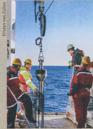
Mit dem Kolben werden Sedimentproben vom Meeresgrund entnommen.
