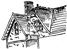
Fig. 1. Fehlerhafte Anordnung der Ausmündung von Ventilationsrohren in der Nähe von Fenstern.
