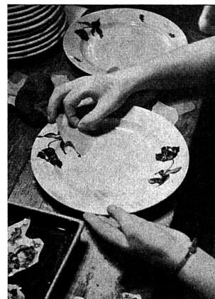
Un des procédés de décoration les plus simples est la décalcomanie, c'est-à-dire l'application sur l'objet d'un décalque coloré, reproduit à l'aide de pierres lithographiques.
