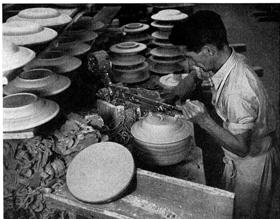
Der Teller ist fertig übergeformt, die Schablone wird abgehoben, der vorläufig noch auf der Gipsform verbleibende Teller geht weiter zum Trocknen.
