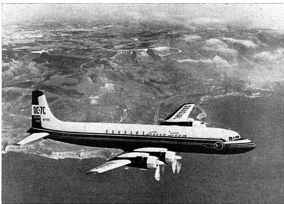
Atteignant la vitesse de 560 à 600 kilomètres à l'heure, transportant à son bord quarante à soixante-dix passagers, selon son aménagement intérieur, le Douglas DC-7 «Seven Seas» est l'un des long-courriers les plus rapides du moment.
