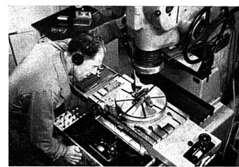
Yverdon: Elektronische Hörkontrolle des Schließens eines Typenhebelgesenkes.
