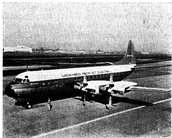
Cinquante-deux tonnes à pleine charge, cent passagers au maximum, quatre turbo-propulseurs, six cent cinquante km à l'heure, voici l'Electra, auquel une piste de treize cents mètres suffit, tant pour le décollage que l'atterrissage.
