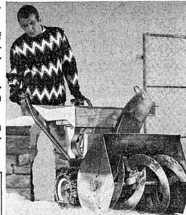
Der starke 6-PS-4-Takt-Lauson-Winter-Motor gewährleistet den Einsatz in jedem Schnee und jeder Witterung. 4 Vorwärtsgänge und 1 Rückwärtsgang. 26" Schneefräse mit 2 Arbeitsstufen. Arbeitsbreite 65 cm. Auswurfrohr um 180° drehbar. Gewicht 135 kg.
