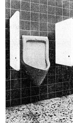
stellt, stossicher und leicht zu reinigen. Die foto-elektronische Steuerung funk-tioniert nach dem Reflexionsprinzip. Ein In-frarotfilter macht den Lichtstrahl unsicht-bar. Die Schaltung steht unter Nieder-spannung und kann ein Elektromagnet-ventil oder eine Wasserspülanlage mit Elektromagnet steuern.
