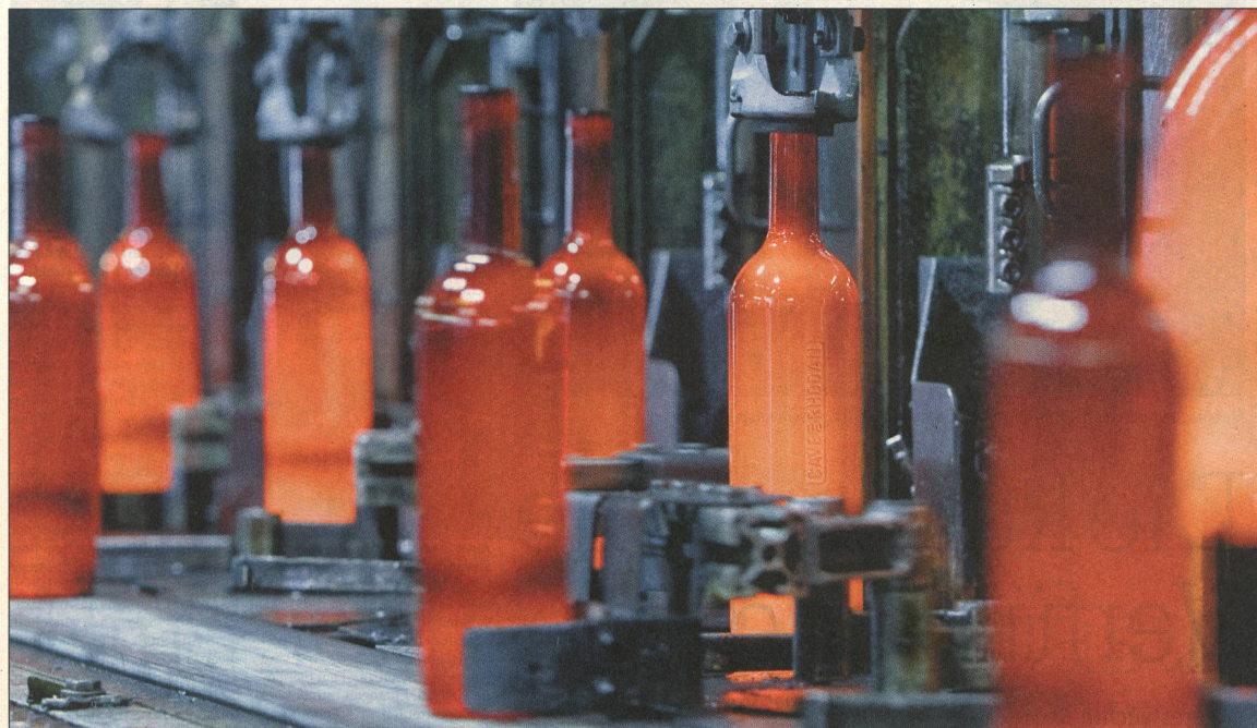
Rotglühend verlassen Flaschen die Glasblasmaschine im Vetropack-Werk St-Prex. Die Flaschen im Bild wurden eigens für die Cave du Rhodan in Salgesch kreiert.
