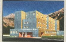
Das Erneuerungsprojekt Jugendherberge bringt einen vierten Stock und damit 86 Betten mehr. Die Fassade wird wärmetechnisch saniert. Die Aussenhülle bekommt eine Holzverkleidung, die je nach Himmelsrichtung in einer anderen Farbe schimmert, von Blau über Grau bis zu Grün und Gelb. Am 12. Juli soll laut «Engadiner Post» ein Teil der Jugendherberge für einen provisorischen Sommerbetrieb eröffnet werden. Ganz fertig ist die Juni dann am 1. Dezember. kjv
