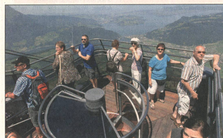
60 Personen fasst die Cabrio-Bahn, davon können 30 aufs Oberdeck. Bei Regen verschliesst eine Schiebetüre die Treppe.
