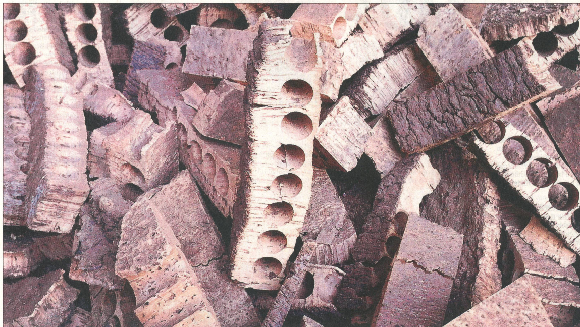
Die Basis der rekonstruierten Zapfen ist Granulat. Der geschmacksfreie Kork wird auch aus Resten der Naturkorkenproduktion hergestellt.
