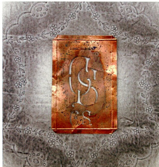
Schablone aus Kupferblech zu Monogramm «CS» auf einer mit Graphitstaub geschwärzten «Stüpfelschablone».
