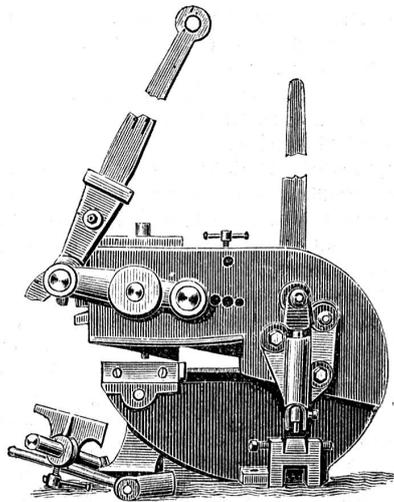
Abbildung der Patent-Hebelblechsheere für 4 und 6 Mm. Bleche.
