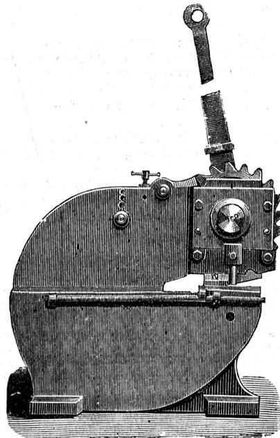
Abbildung der Patent-Hebelblechsheere für 8, 10, 12, 15 Mm. Bleche.
