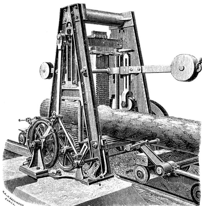
starken Holzrahme. Die Gatterständer sind von Schmiedeeisen (U-Eisen) wie überhaupt das meiste und das Gatter selbst ganz aus Schmiedeeisen und Stahl besteht, um den Bau der Maschine möglichst leicht und doch solid bewerkstelligen zu können.
