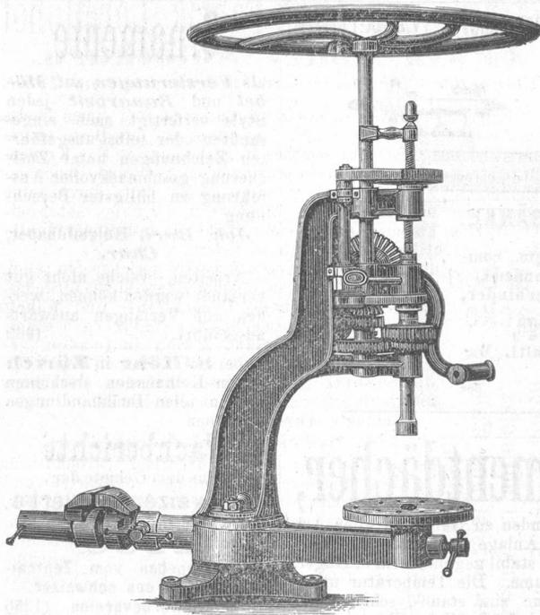
**Tischhänder-Bohrmaschine** für Hand- und Kraftbetrieb mit drehbarem, horizontal verschiebbarem Tisch und Paratellschraubstock, zweifacher Ueberführung, zwei Geschwindigkeiten und Selbstschaltung.
