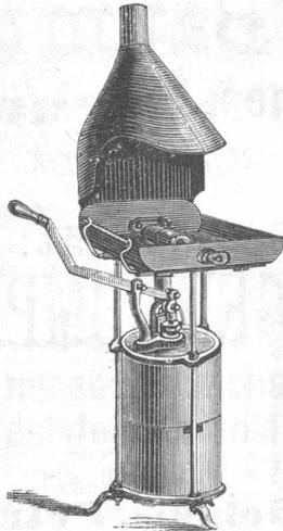
Keine einfache und doppelblatende **Feldschmiede** mit drehbarem Hebel zum Drücken oder Treten. Gußeiserne Esse, Boden- und Deckelplatten.
