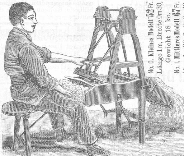
Diese Zupfmaschine zupft, kämmt und entstaubt alle Polsterstoffe besser als andere Systeme, ohne das Material irgendwie zu verderben. [725
