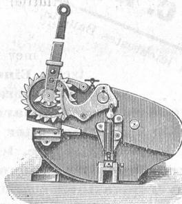
Diese Scheeren werden als Hebelscheeren von 4 bis 15 m/m starke Bleche und für Hand- und Motorbetrieb von 10 bis 25 m/m starke Bleche hergestellt.
