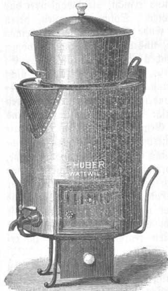
Wenn nun gefeuert wird, so erhält man das im Ofen befindliche Wasser (etwas mehr als im eigentlichen Wäschhafen) gratis warm. Hiedurch, sowie durch die vorzügliche Feuerungsanlage werden bis 50% Brennmaterial erspart. Das warme Wasser wird oben ausgelassen, indem man das kalte Wasser unten einströmen läßt, sei es durch einen Trichter mit Rohrverbindung oder durch die Druckwasserleitung. Im Winter soll der Ofen entleert werden, damit das Wasser nicht einfriert und den Kessel zerreißt.
