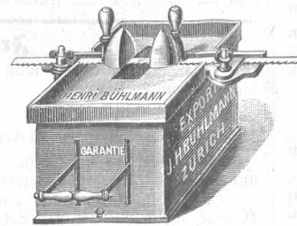
Das denkbar Einfachste das Billigste und das garantiert Zuverlässigste zum Bandsägenlöthen ist dieser schöne solid gebaute Apparat.
