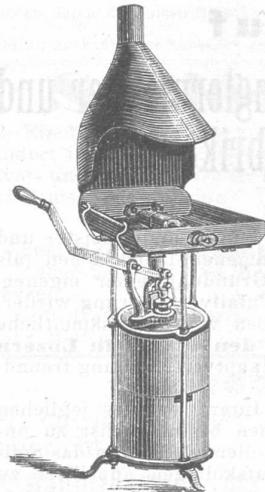
**Feldschmiede mit Cylindergebläse**, mit oder ohne Rauchfang u. Wasserbehälter, drehbarem Hebel zum Drücken oder Treten; in 6 Grössen.
