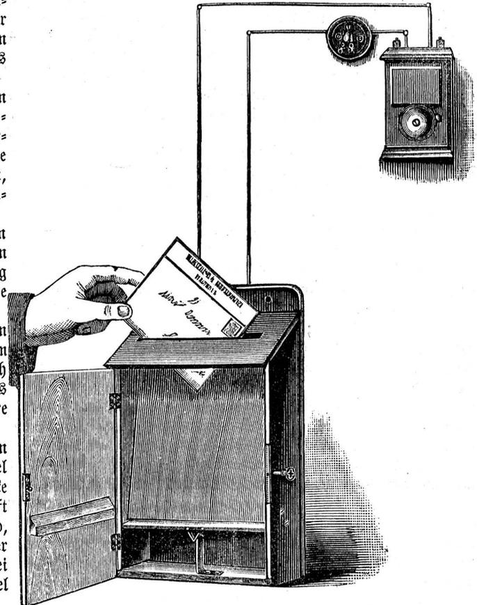
Ende, als derselbe mit einer Contact-Vorrichtung versehen ist, die beim Einschleiben des Briefstückes den Stromkreis schließt und dadurch ein elektr. Läutewerk unmittelbar oder auf den Druck eines Knopfes in Thätigkeit setzt.
