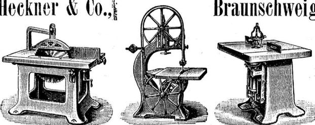
Kreissäge. Bandsäge. Fräs-Maschine.
