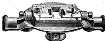
Billiger Preis, einfachste Behandlung, Backen verstellbar und zweitheilig, Gewinde auf einen Schnitt, geringes Gewicht, Garantie für Leistungsfähigkeit und gute Qualität. [46
