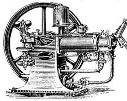
**Gasmotoren** für Leuchtgas.
