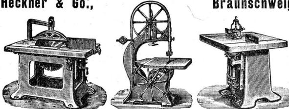
707] Kreissäge Bandsäge Fräsmaschine
