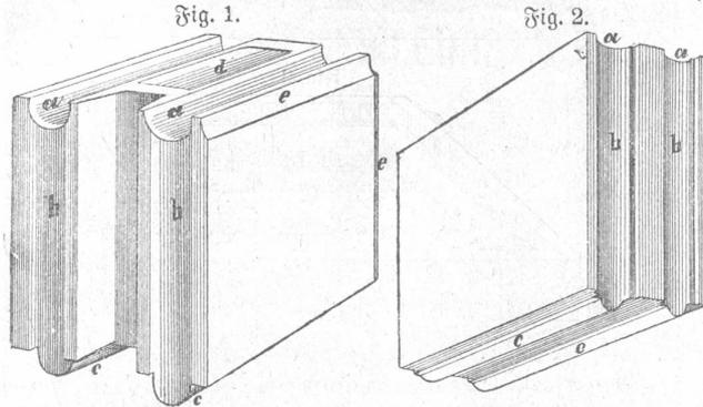
Fig. 1 zeigt einen Falzbaustein, wie solche für äußere Fassaden-Mauerwerke am vorteilhaftesten sein dürften. Die natürliche Größe bei diesem System ist: 50 cm Länge, 30 cm Höhe. Die Dicke hat der Mauerstärke zu entsprechen, bei Fig. 1 25 cm. Die Größe kann selbstverständlich nach Belieben angewandt werden.
