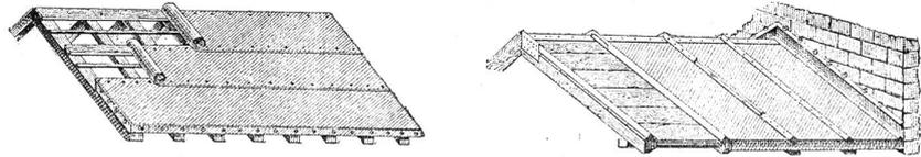
**Längsdeckung ohne Verschalung. Leistendeckung m. Maueranschluss von Gebäuden jeder Art, besonders Fabriken, Schuppen, Hallen etc.**
