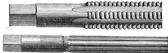
Schneidklappen für Gasrohre neuester Konstruktion.
