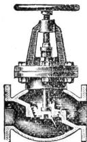
Durch mehrsitigen Kegel garantiert dauernd dichter Schluss u. demzufolge bedeutende Dampf-(Kohlen)-Ersparnis. — Kein Nachschleifen
