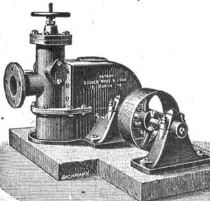
für Hochdruck, mit patentierten Löffelrädern, mit oder ohne automatischen Regulator.
