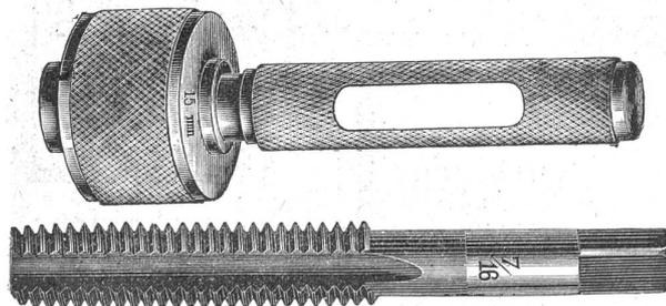
Gewindeschneidzeuge für Gas-, Whitworth-, Bodmer- und Löwenherzgewinde mit schrägen oder Reinecker-Patent-Kluppen.
