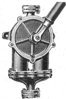
**Neue doppelwirkende Kolbenpumpe**
