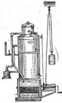
Erzeugt selbstthätig weisses Leucht- u. Heizgas aus Gasolin, ohne Feuerung, ohne Geruch, überall aufzustellen genehmigt, ist verwendbar wie Kohlgas zu Gasglühlicht, z. Kochen, Heizen, Löten, Chem. und techn. Laboratorium (Bunsenbrenner).
