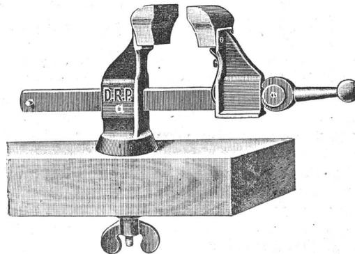
Mit Hilfe des Griffes a schiebt man die vordere Backe an das Arbeitsstück, drückt den Griff nach unten und das Stück sitzt absolut fest. Der Schraubstock hat ferner die Annehmlichkeit, an jede Hobel- und Werkbank durch die Schraube mit Flügelmutter schnell befestigt zu werden und ist nach jeder Seite hin drehbar. Abnutzung und Reparatur ist gänzlich ausgeschlossen. Gewicht ca. 10 kg. Erhältlich zum Preise von Fr. 16 bei J. Schwarzenbach, Genf.
