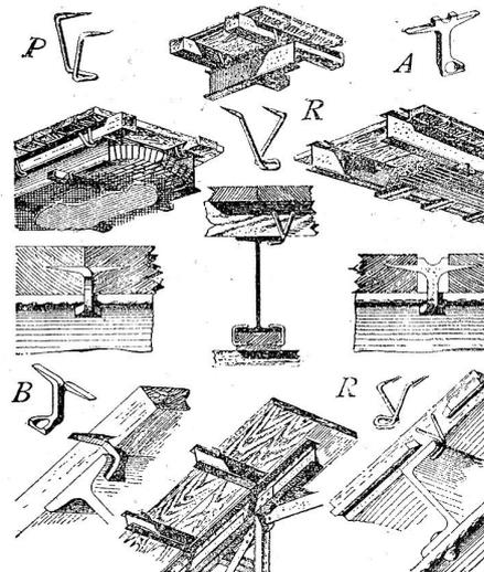
A & B verbinden stumpfe Bretter direkt mit I Eisen.
