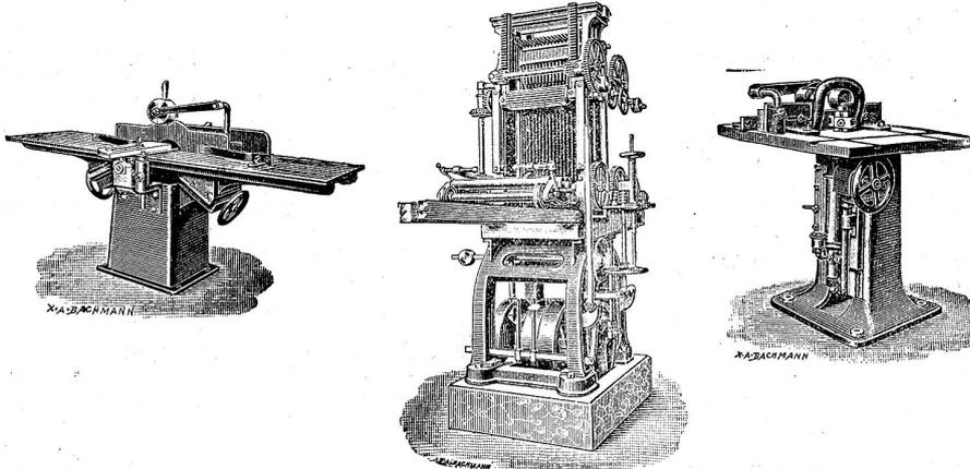
**Vollgatter, Bandsägen, Cirkularsagen** zum Schneiden von Brennholz und für die Tischlerei, **Langholzfräsen, Kehlmaschinen**, mit allen nötigen Einsätzen. **Ein-, drei- und vierseitige Walzenhobelmaschinen, Abrichtmaschinen.** **Hobelmesserschleifapparate. Langlochbohr- und Stemm-Maschinen** in gediegenster Ausführung und den neuesten Verbesserungen.
