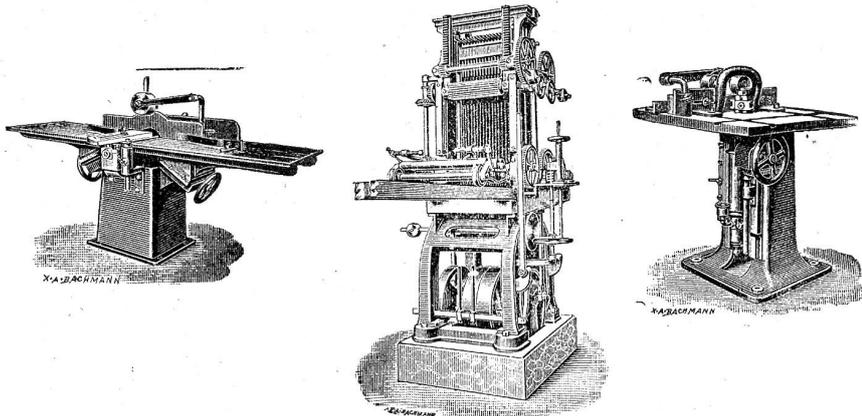
Vollgatter. Bandsägen, Cirkularsägen zum Schneiden von Brennholz und für die Tischlerei, Langholzfrais, Kehlmaschinen, mit allen nötigen Ein-sätzen. Ein-, drei- und vierseitige Walzenhobelmaschinen, Abrichtmaschinen. Hobelmesserschleifapparate. Langlochbohr- und Stemm-Maschinen in ge-diegenster Ausführung und den neuesten Verbesserungen.
