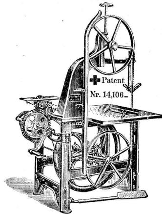
Durch Anordnung der Kugellager ist die geringste Reibung, dadurch der leichteste Gang erzielt und damit die Leistungsfähigkeit auf das höchste, was von einer Bandsäge für Hand und Fussbetrieb verlangt werden darf, gesteigert.
