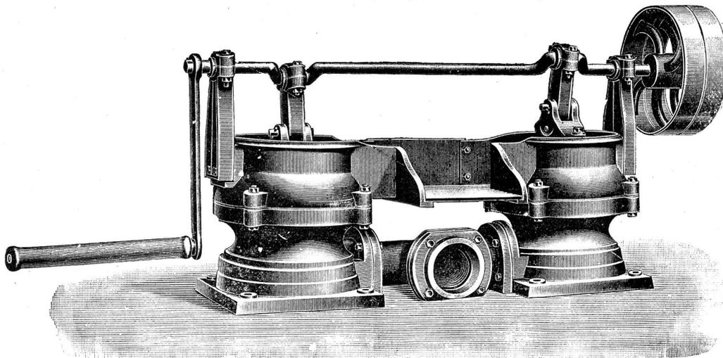
nischem Betriebe der Pumpe ist es ratsam, derselben nicht mehr als 50 Touren Geschwindigkeit zu geben. Es ersetzt die Diaphragma-Pumpe in vielen Fällen eine Centrifugalpumpe. Diese Diaphragma-Systeme sind ohne Plunger oder Cylinder konstruirt und erfordert die Bewegung des Diaphragmas (Gummi-zwischenwand) nur ganz geringe Kraft und kleinen
