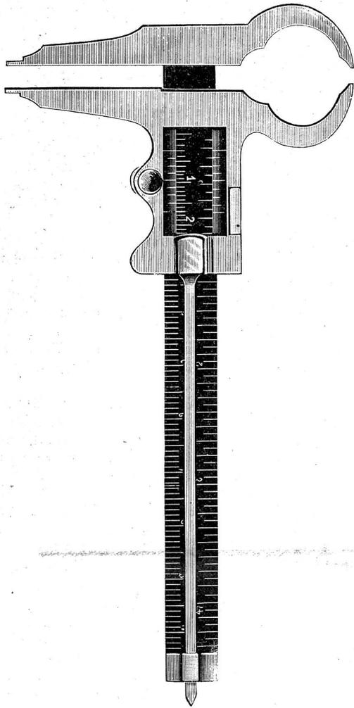
Der am Kaliber angebrachte nach unten zugespitzte Stab gestattet auch die Tiefe der Löcher schon von 2 mm an zu messen und macht besonders dieser letztere Bestandteil diesen Kaliber zu dem so beliebten Maßwerkzeug.
