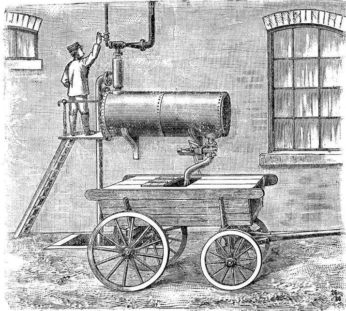
über dem Erdboden angebracht, daß sein Inhalt in einen untergeschobenen Wagen frei abfließen kann. Derselbe, zweckmäßig aus Eisen angefertigt, ist mit einem Dampfstrahlluftsauger, sowie mit einer nach der Grube führenden Saugleitung fest verbunden. Die Ablaufleitung, die zum Transportgefäße führt, ist durch einen
