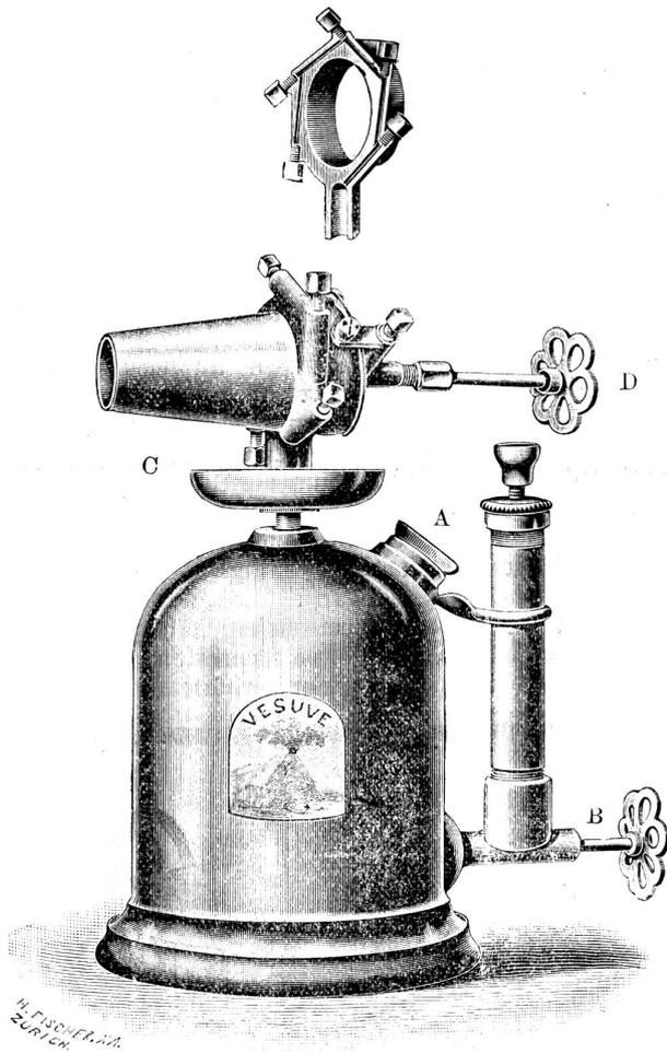
Als Brennmaterial dient außer Benzin auch Spiritus, Kerosin und Petrol. Der Verbrauch an Brennstoff ist sehr gering, indem die vom Brenner angefaugte Luft mehr als die Hälfte des Bedarfes der Lötlampe repräsentiert.
