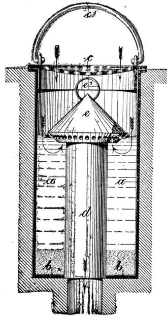
mehr oder minder vertikalen Bohrungen des Siebes e gestatten dem Wasser fallenden Eintritt in den äußern Rohrstutzen a b, währenddem die ansteigend gebohrten Löcher des innern Siebes e das Wasser nur in mehr oder weniger aufwärts laufender Richtung ausfließen lassen, welche letztere Anordnung bezweckt, daß sich allfälliger Schlamm in dem durch die äußern und innern
